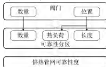
图 2 故障元件（可靠性分区及阀门）与热网可靠度的关系
